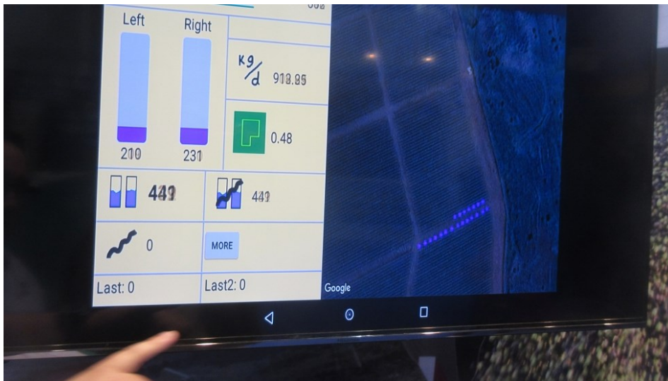
Monitor de rendimiento (Doc. New Holland), cit Roldan et al., 2021)
